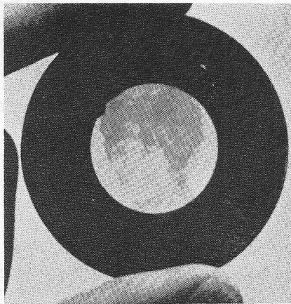
Afb. 2 Aan een foto ontleend beeld, vastgelegd in een „Cerampic“-cel, die in deze vorm net als een dia kan worden geprojecteerd.
